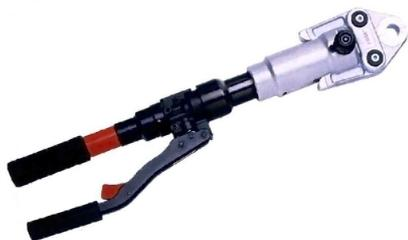
Гидравлический ручной пресс для обжима фитингов от 12 до 63 мм. Двухскоростная система подачи поршня. Щелчок по окончании обжима. Всегда гарантированный обжим. Головка поворачивается на 360 градусов. Профиль клещей: В, F, G, H, HA, M, SA, TH, U, V, VP. Поставляется в ящике без клещей.
