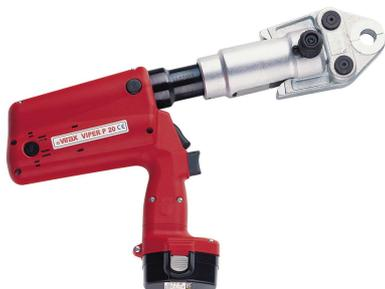
Электрогидравлический пресс для обжима фитингов от 12 до 63 мм. Легкий и эргономичный. (Вес 5.1 кг). 20'000 обжимов без тех. обслуживания. Электронный контроль качества обжима. Щелчок по окончании обжима. Всегда гарантированный обжим. Головка поворачивается на 360 градусов. **Аккумуляторная батарея** 14,4 V, 2.6 Ah + зарядное уст-во. Профиль клещей: В, F, G, H, HA, M, SA, TH, U, V, VP.
