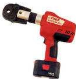
Применяется для труб PEX, PER, PEX/AL/PEX от 12 до 32мм., для медных труб от 12 до 28 мм. Управляется микроконтроллером, имеет автоматический возврат, компактный и удобный. Оснащен поворачивающийся головкой на 180 градусов. Управление осуществляется одной кнопкой. Легкий вес 3,6 кг. (без клещей 1,2 кг.) Сверхбыстрый, обжим 32 мм за 4 секунды.
