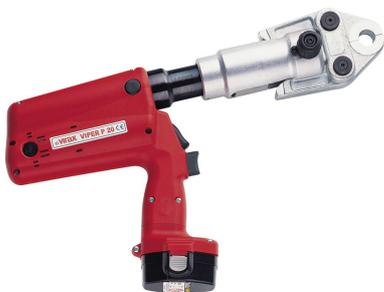
Электрогидравлический пресс для обжима фитингов от 12 до 63 мм. Легкий и эргономичный. (Вес 5.1 кг). 20'000 обжимов без тех. обслуживания. Электронный контроль качества обжима. Щелчок по окончании обжима. Всегда гарантированный обжим. Головка поворачивается на 360 градусов. **Аккумуляторная батарея** 14,4 V, 2.6 Ah + зарядное уст-во. Профиль клещей: В, F, G, H, HA, M, SA, TH, U, V, VP.
